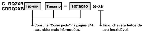
O aço inoxidável é usado como material substituto para peças padrão quando usadas em condições com a possibilidade de oxidação ou decomposição.
