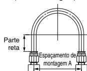
Fig. 1 Configuração recomendada para a tubulação
