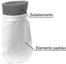
Tem uma estrutura de maneira que o material de filtragem esponjoso, que é feito de cloretos de polivinilideno, tenha a forma de um saco. Ele é, então, fixado por um anel dentro do elemento padrão.
