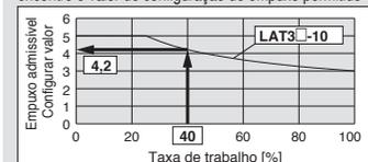
A partir da Fig. 5: LAT3□-10, direção de pressionamento distante do conector na posição de pressionamento 4 mm, encontre Fmax = 4,5
