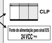
Nota) Quando a conformidade UL for requerida, o atuador elétrico e a unidade devem ser usados com a fonte de alimentação UL1310 Classe 2.
