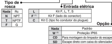
Nota 1) Montagem do conector DB25 para o lado D: VVQ4000-19A-D não está incluído. (Peça separadamente)
